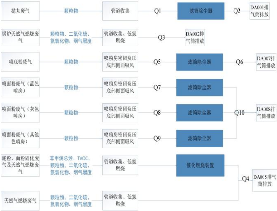
图 4.1-4 有组织废气走向及监测点位图
